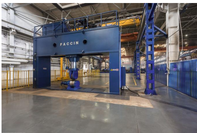
Рис. 4. Пресс «Faccin» PPM-500/6 (Италия) для трёхмерной гибки листового металла
