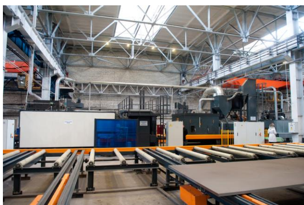
Рис. 1. Линия очистки металла ORANGE 25.6 фирмы Gietart.me (Нидерланды)
