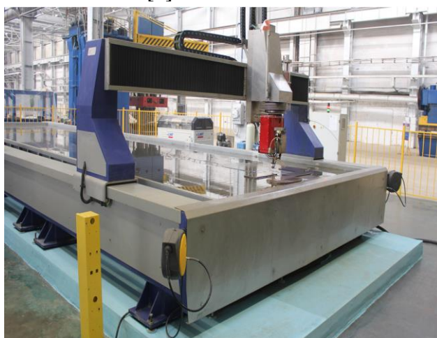
Рис. 3. Автомат для гидроабразивной резки листового проката «MODULA»(Италия)
