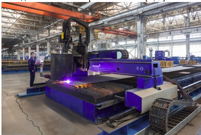
Рис. 2. Машина плазменной резки Messer(Германия)
