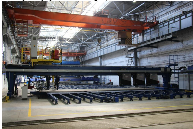
Рис. 5. Механизированная поточная линия сборки и сварки плоских секций и мостовых конструкций фирмы IMG (Германия)
