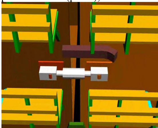
Рис.8. «Стяжка» блоков талрепами
