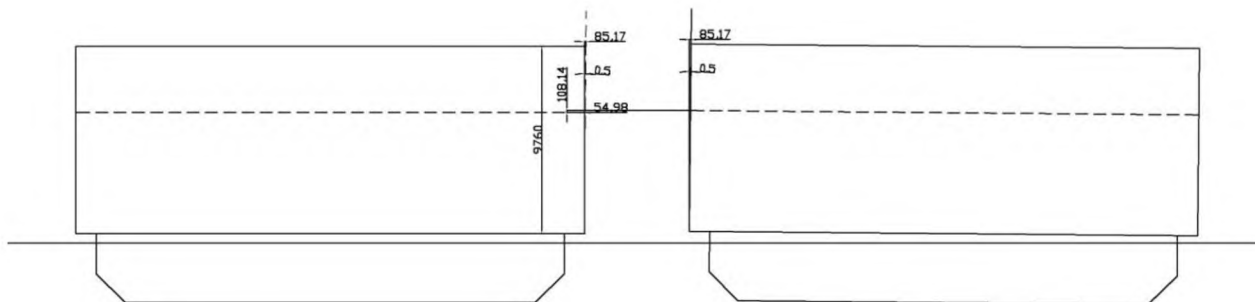
Рис. 4. – Схема предельных положений в зависимости от заламывания обухов
