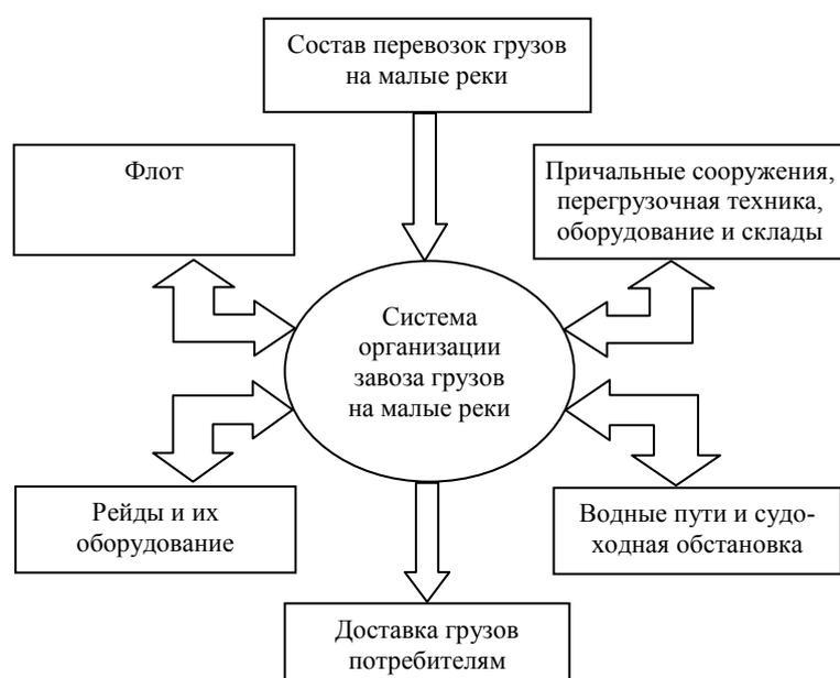
Рис. 1. Схема взаимодействия элементов воднотранспортной системы доставки грузов
