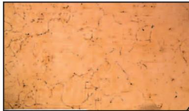
Рис. 12. Микроструктура металла основы, увеличение  $\times 50$
