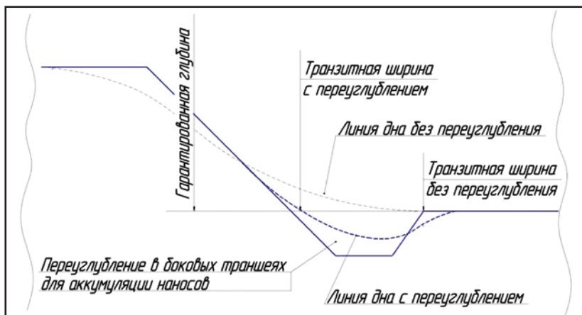
Рис. 1. Разработка дноуглубительной прорези с переуглублением крайних траншей
