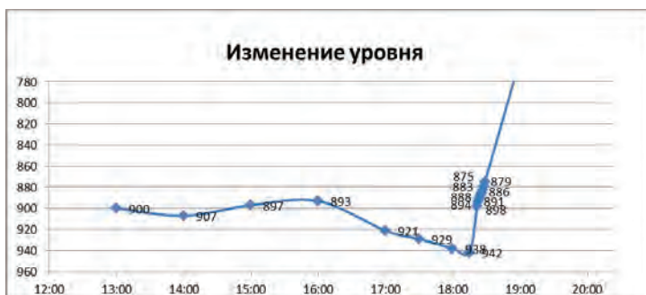
Рисунок 2. График примера записи уровня сигнализатором начала ГНВП
